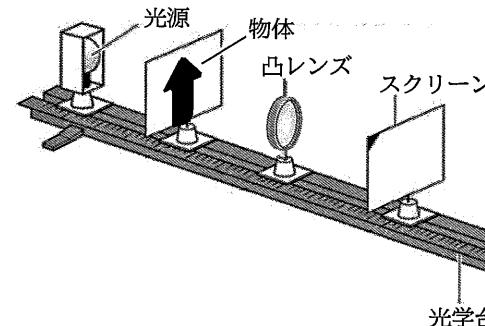
1 図2のように、物体をレンズの焦点距離の2倍となる位置に置いた。スクリーンを動かしたときに、物体と同じ大きさの像ができる位置を図2のアからエまでの間から1つ選び、記号で答えなさい。また、このときスクリーンに映る像は、実像と虚像のうちどちらか。答えなさい。
