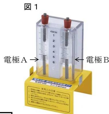
電極Aと同じ気体が発生し、②の電極Bは色をつけたろ紙を近づけると色が消えることから、**実験1**の水酸化ナトリウム水溶液の電極Bとは異なる気体であることが確認できた。
